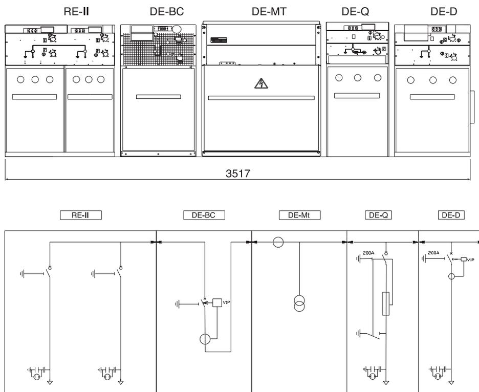
MV配电变电站，带站用PT — 方案三
