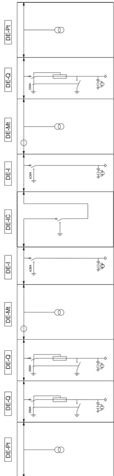
MV配电变电站，带计量 — 方案二
