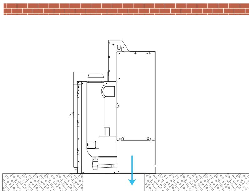
注：用以引导气体排向通风口和冷却墙的组件不是开关柜的组成部分，但它们必须按照实际情况进行准备。
