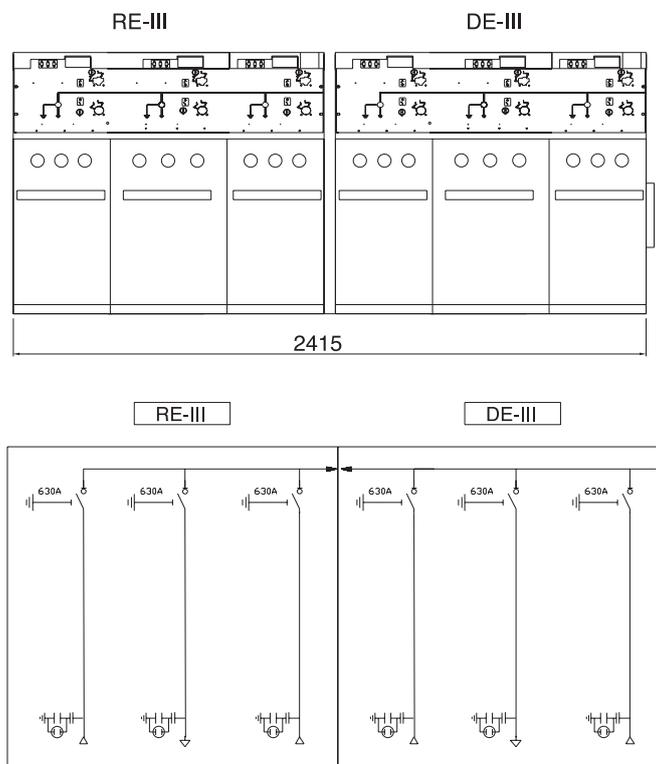
MV/LV终端变电站 — 方案五
