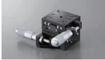
■在移動導軌上採用交叉滾子、進給結構上採用分厘卡測頭的高精度轉動滑台。旋轉中心振動精度為0.01mm以下(1軸)的高精度。最適合細微定位等用途。
