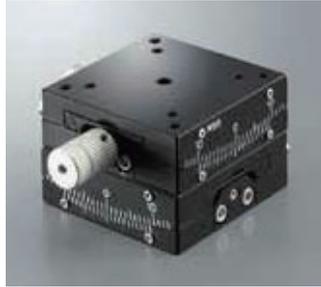
■ 在移動導軌上採用鳩尾槽式、進給結構上採用蝸桿傳動的高性價比側角滑台。可廣泛用於研究開發～裝置內部・治具用途。
