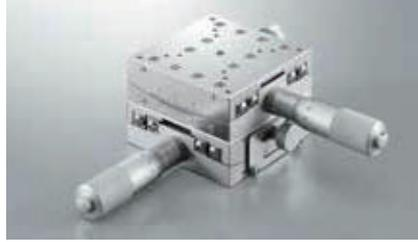
■ 在移動導軌上採用交叉滾子、結構上採用分厘卡測頭的高精度轉動滑台。旋轉中心振動精度為0.01mm以下(1軸)的高精度。最適合細微定位等用途。
