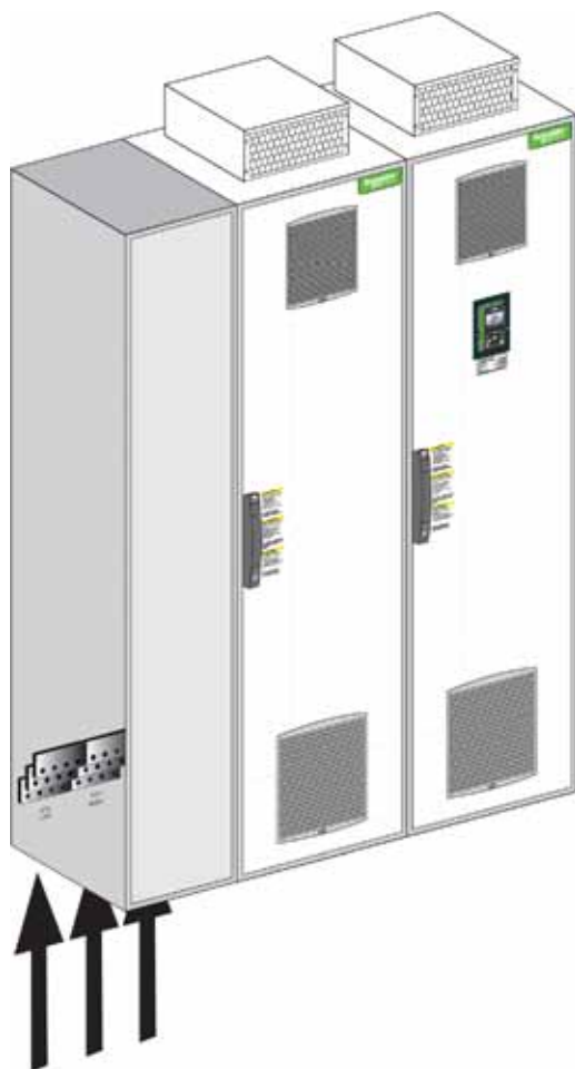
可实现从底部布线的附加机柜
